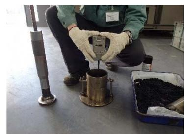
写真-2 貫入抵抗試験状況
