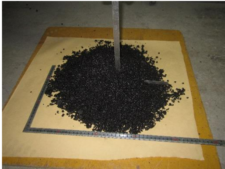
写真-1 スランプ測定の様子
