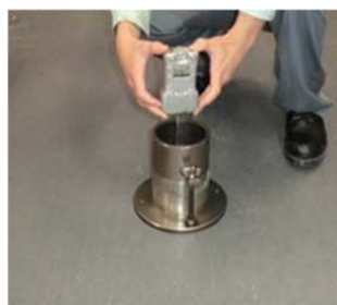
写真-2 貫入抵抗試験
