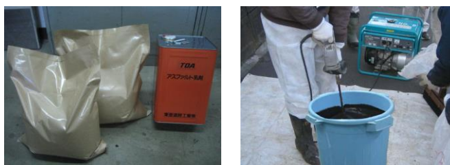
写真-1 市場に流通している常温硬化型補修材のパッケージと混合物製造状況の一例
