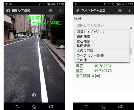
図-3 スマホによる点検・補修記録
