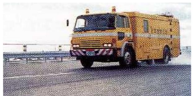
図8 大型車すべり測定車によるすべり摩擦係数の測定
