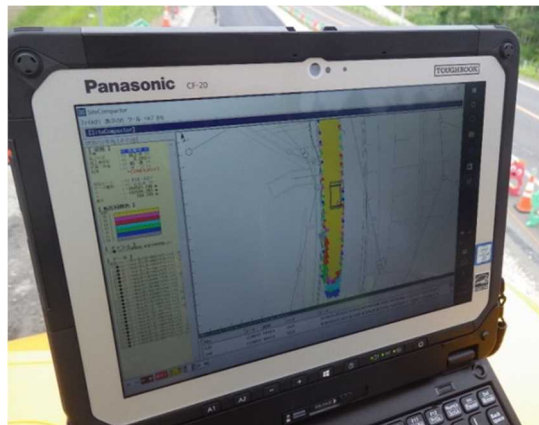
写真-3 施工中の転圧状況の表示例
