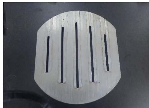
写真-6 底板のスリット
