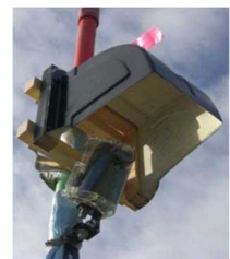
写真-1 固定式インターバルカメラの設置状況
