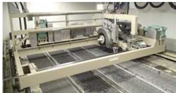
写真-1 室内凍結路面走行試験装置
