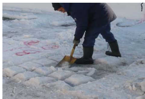
写真-4 除雪の容易さ試験状況
