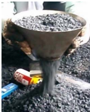
写真－2 フロー試験
