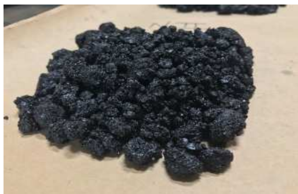
写真-1 混入率 15%配合の煮沸前の状況
