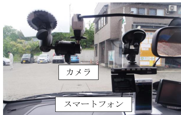
写真-1 測定機器の設置状況
