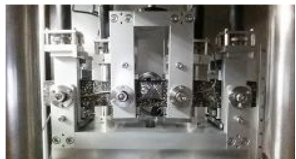
写真-1 4点曲げ疲労試験の実施状況
