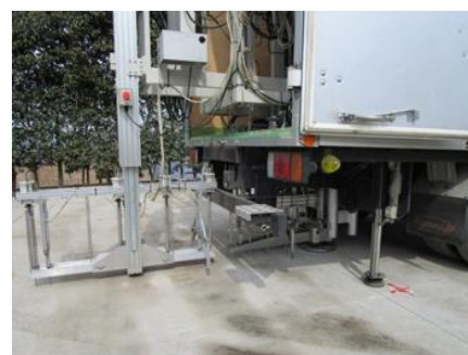
写真-3 FWD 測定状況
