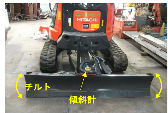
写真-5 排土板のチルト機構および傾斜計
