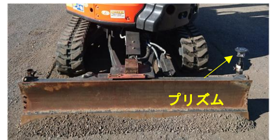
写真-6 プリズムの取り付け
