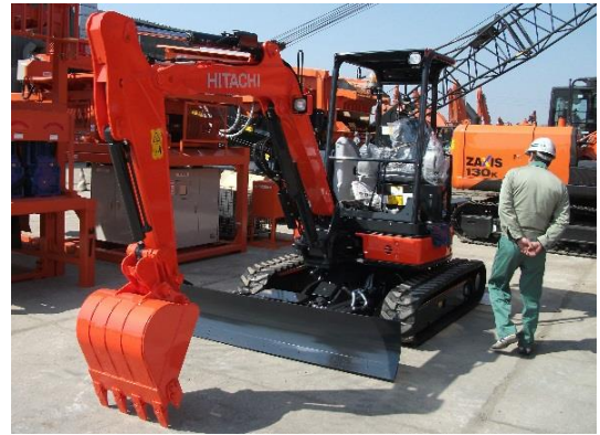
写真-4 ベースとしたミニバックホウ
