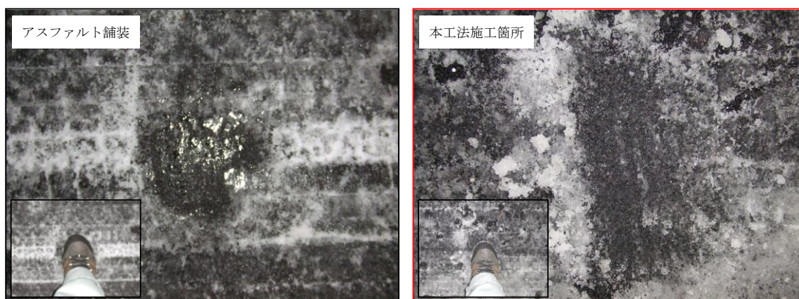
写真-3 凍結抑制効果の確認 (H25.2.8)
