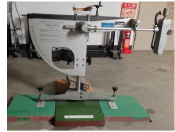
写真-2 すべり抵抗試験機
