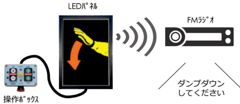
図-3 音声ガイダンスとパネル表示の同期制御のイメージ
