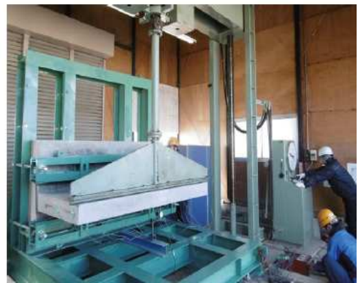
写真-10. 監視員通路壁載荷試験状況
