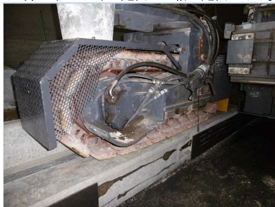
写真－7. スリップフォームペーパー走行状況
